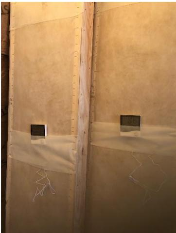
【温度湿度計を装着した試験体】
