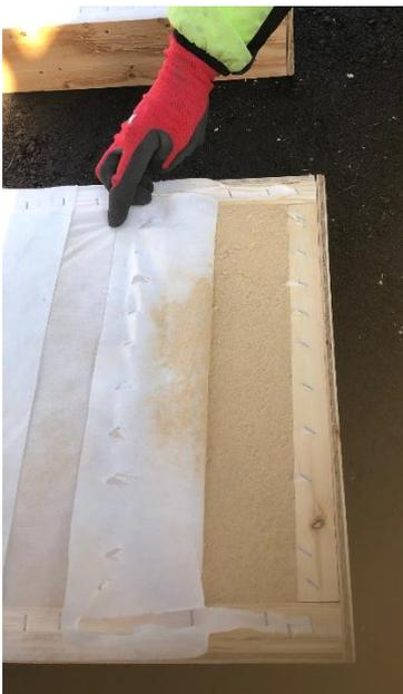
【1 か月後の測定作業、シートを取った上部に沈下による隙間は見られなかった】
